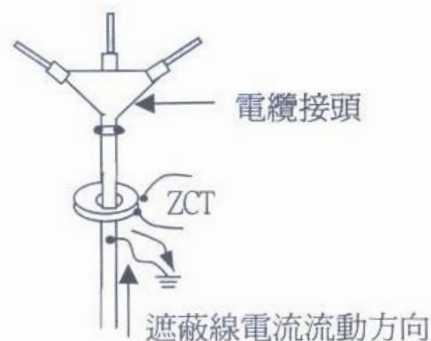
圖 2-3 正確的接地方法
