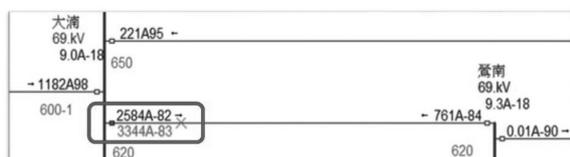
圖 11 以 ASPEN 軟體模擬相同故障電流
