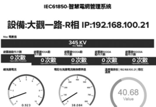
圖 12 ABB IEC 61850 Excount-III 避雷器線上監測系統示意圖
