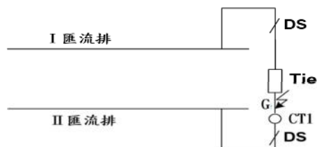
圖4 匯流排聯絡斷路器單CT死區故障示意圖
