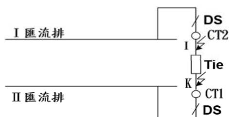
圖5 匯流排聯絡斷路器雙CT死區故障示意圖
