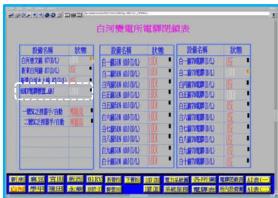
圖 26 白河 S/S ADCC 圖控電驛群組
