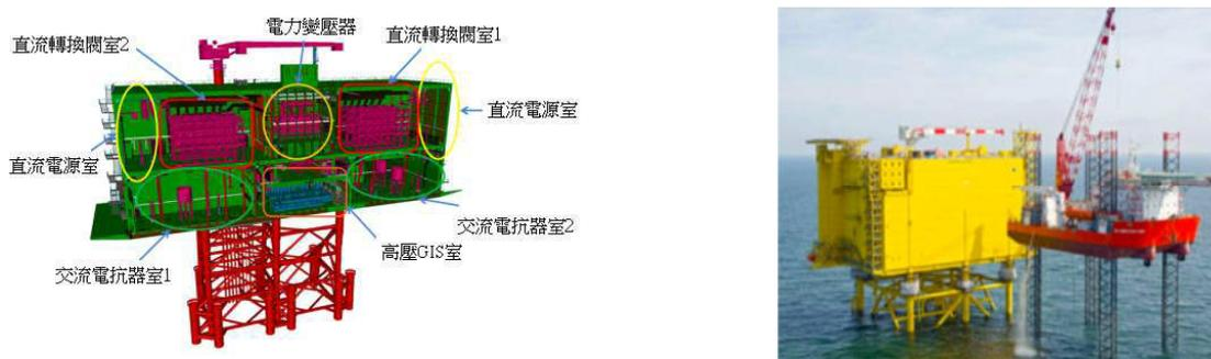
圖24 HVDC離岸轉換器變電站構造示意圖及外型圖
