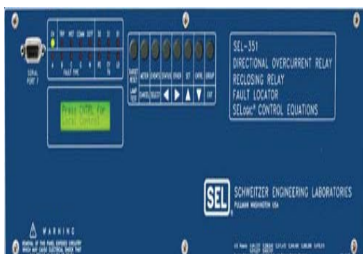
圖五. SEL-351型數位電驛
