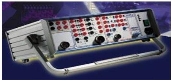
圖一 電驛測試儀器 ISA
